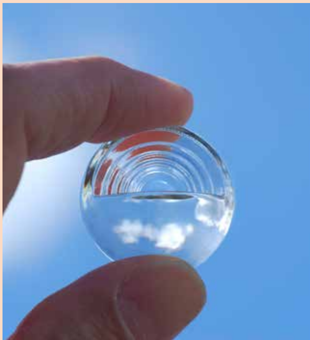
De lenzen van LUXeXcel worden niet in laagjes opgebouwd, zoals dat gebruikelijk is bij klassiek 3D-printen. Het bedrijf heeft een alternatieve methode waarbij men het plastic of de kunststof op een druppelvormige manier aanbrengt en telkens uithardt door het belichten met ultraviolet.
